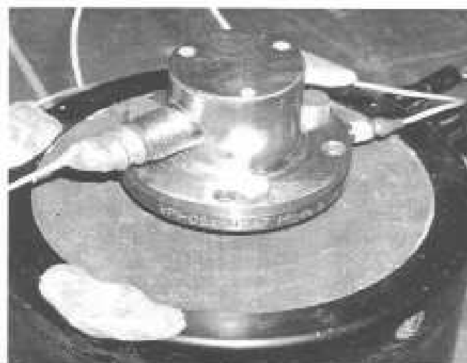
Рисунок 3 – Внешний вид виброметров УС-093 и УСТ-096 (слева) и вибростенда с размещенными эталонным и калибруемым вибропреобразователями (справа)
