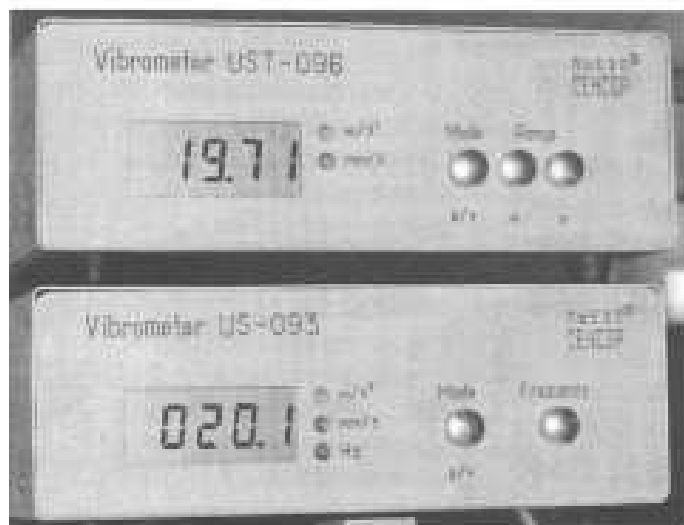
Рисунок 3 – Внешний вид виброметров УС-093 и УСТ-096 (слева) и вибростенда с размещенными эталонным и калибруемым вибропреобразователями (справа)
