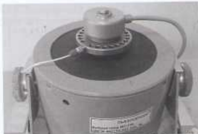
Рисунок 4 – Установка датчика ВПЭ-085-Т на вибростоле ВС ВКК-128
