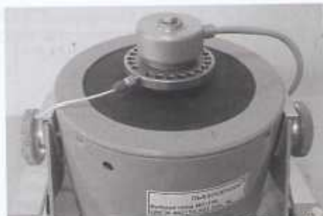
Рисунок 4 – Установка датчика ВПЭ-085-Т на вибростоле ВС ВКК-128
